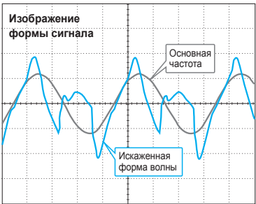
*Формы волны получены при измерении на распределительной панели офиса корпорации Yokogawa Meters & Instruments
